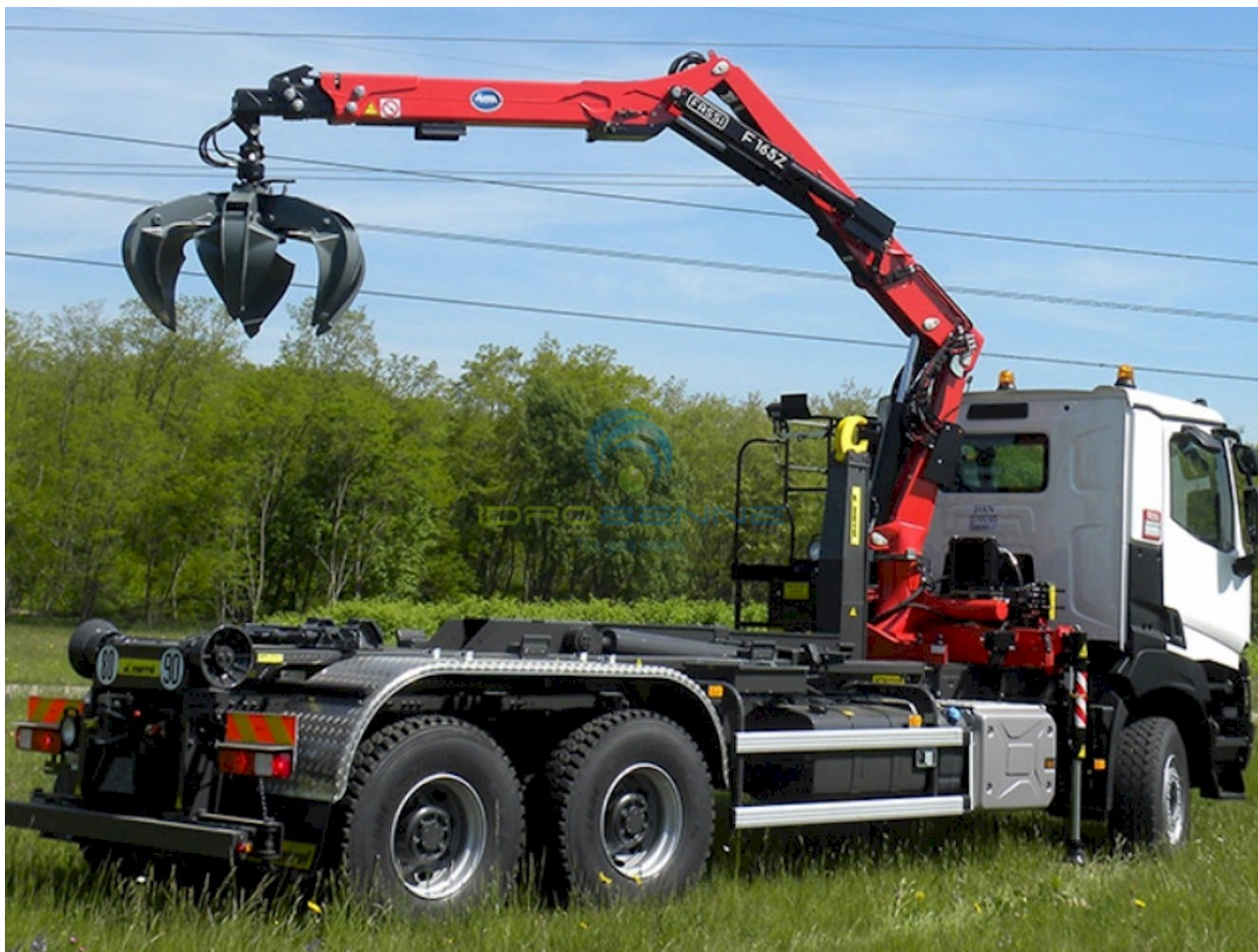
Figura 7 - Immagine esemplificativa del "polpo" e dell' autogrù da utilizzare.
